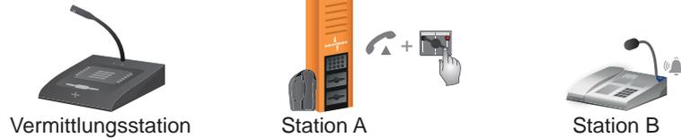
Temporäre Duplexverbindung ist eingerichtet. Bediener an Station A hebt den Handhörer ab und drückt einmal kurz seine Vermittlungssprechtaste. An Station B ertönt ein Klingelton.
