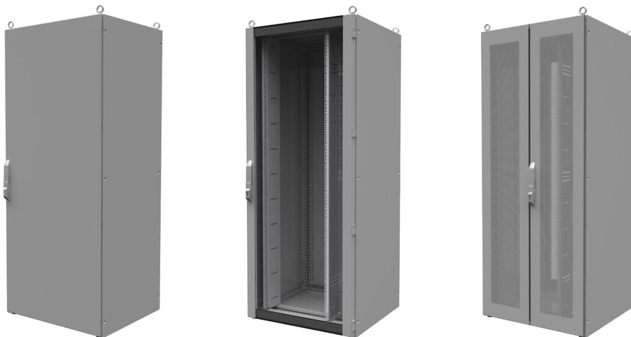
Die Schrankserie CAB 01 wird zur Aufnahme von INDUSTRONIC Systemkomponenten eingesetzt. Die Schränke basieren auf der innovativen VX25-Serie und bestehen aus stabilen Stahlblechwänden, die an einem Stahlprofilrahmen mit Dichtung angeschraubt sind und wahlweise abgenommen werden können. Sie sind in den Schranktiefen 600 mm und 800 mm verfügbar.
